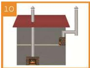
Необходимо своевременно очищать дымоход от продуктов сгорания, таких, как сажа, креозот, слабоконцентрированные кислотосодержащие соединения перед началом, в конце, а также в течение всего отопительного сезона не реже:
