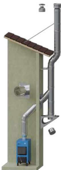
Для котла/печи вдоль наружной стены
