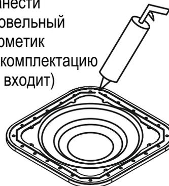
**4** Устанавливаем проходной элемент EPDM. Монтируем крест на крест на кровельные саморезы
